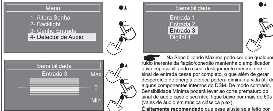
Na Sensibilidade Máxima pode ser que qualquer ruído inerente da fiação/conexão mantenha o amplificador ativo impossibilitando o seu desligamento mesmo que o sinal de entrada cesse por completo, o que além de gerar desperdício de energia elétrica poderá diminuir a vida útil de alguns componentes internos do DSM. De modo contrário, Sensibilidade Mínima poderá levar ao corte prematuro do sinal de áudio caso o seu nível fique baixo por mais de 60s (vales de áudio em música clássica p.ex).
